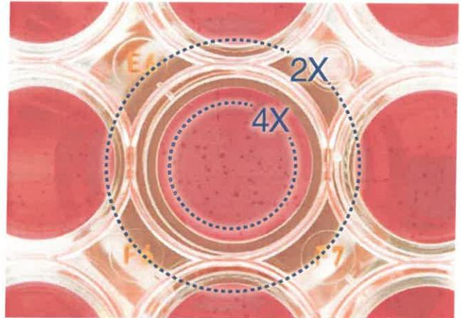
En visualisant une plaque à 96 puits, le large champ visuel permet d'observer toutes les cellules dans un puits sans avoir à déplacer la platine.
