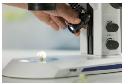
Spot LED simple focalisable et réglable en hauteur pour éclairage rasant de l'arrière
