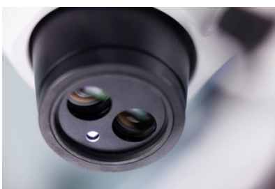
LED en position quasi-verticale pour illumination des trous
