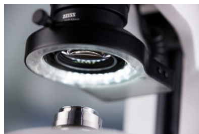
Eclairage annulaire LED segmentable pour les éclairage sans ombre ou bien pour choisir l'orientation de l'ombre
