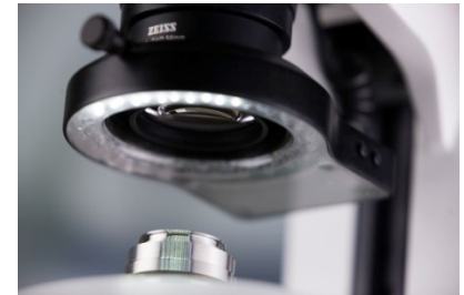
Eclairage annulaire LED segmentable pour les éclairage sans ombre ou bien pour choisir l'orientation de l'ombre
