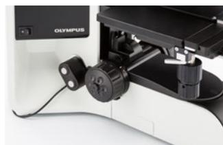
Interrupteur de commande manuelle de la rotation de la tourelle porte-objectifs motorisée
