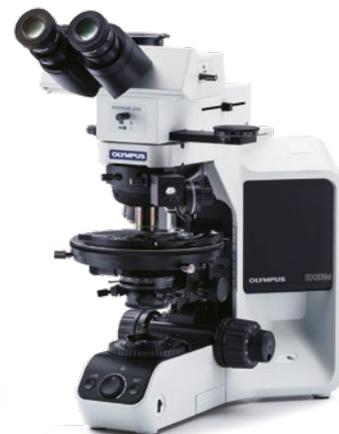
Configuration du BX53M pour observation conoscopique/orthoscopique
