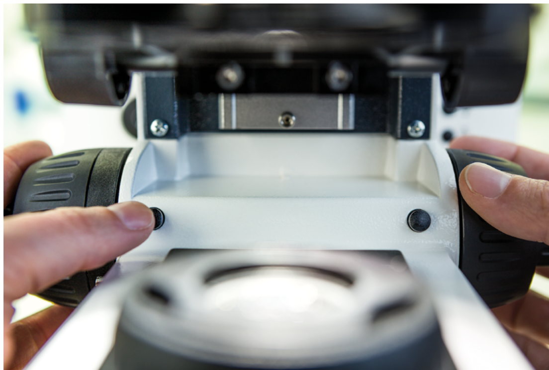
Axioscope 5 : bouton d'instantané pour acquisition d'image de chaque côté
